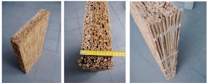
Abb. 3: Schilfrohrplatte mit aufgeschäumtem Thermoplast als Bindemittel, Prototyp Nr. P.14 (Quelle: [4], S.84)
